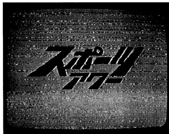
写真6.1 整流子モーターのパルス雑音 (ヘッドライアー)
