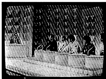
写真10.6 ホームビデオの局部発振の高調波による 障害画面症状
