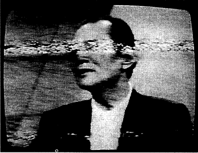
写真5.6 新幹線による画面症状 (新幹線の電源周波数が60Hzの 場合)
