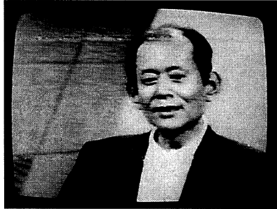
写真5.7 新幹線による画面症状 (雑音発生が比較的少ない例)
